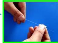
6. Verwenden Sie ein Faserbeil, um die Faser zu schneiden (stellen Sie sicher, dass die Endfläche nach dem Schneiden flach ist).
