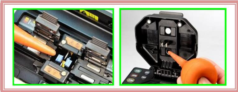
Wenn die routinemäßige Wartung längere Zeit nicht durchgeführt wird, ist die optische Kamera mit Staub bedeckt, wodurch das Glasfaserbild weiß oder unscharf wird.
