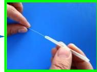
5. Entfernen Sie den Fasermantel und den Liner und reinigen Sie die Faser mit Alkohol.
