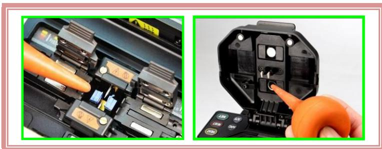
Étant donné que l'épisseuse par fusion fonctionne souvent dans un environnement médiocre, si la maintenance de routine n'est pas effectuée fréquemment, une grande quantité de poussière collera à la caméra CMOS, ce qui provoquera une image de fibre blanche et floue.
